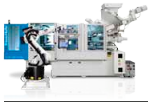
Dieses Beispiel einer 3.500 kN-Spritzgiessmaschine zeigt eine spezielle Polyester-Stopfvorrichtung zur Verarbeitung von BMC-Duroplasten mit 6-Achs-Roboter für die automatisierte Nachbearbeitung.
